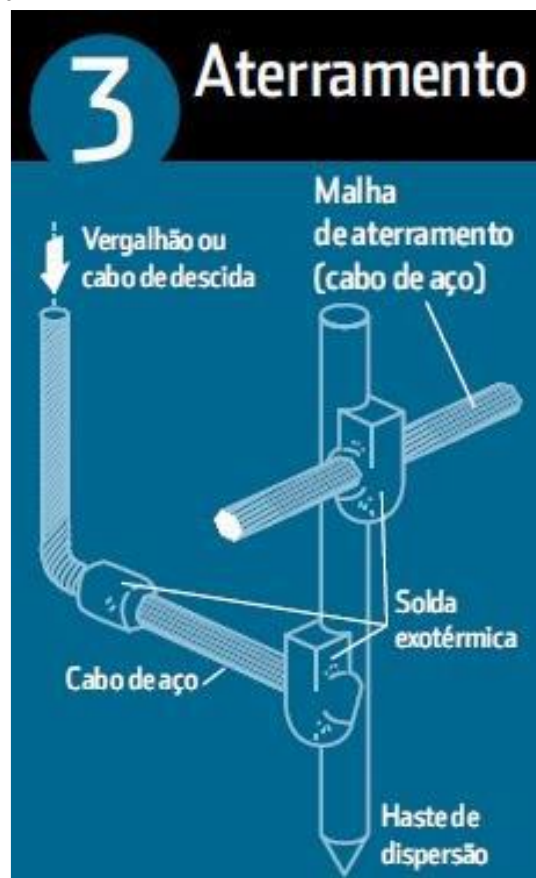
Exemplo de Ligações da Malha de Aterramento.
