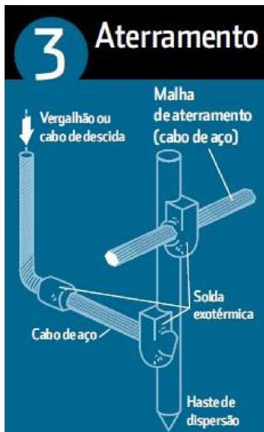
Exemplo de Ligações da Malha de Aterramento.
